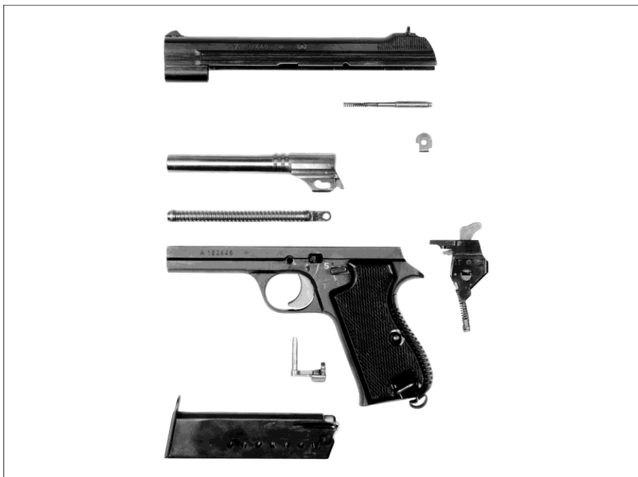
Abbildung 4: Zerlegung für die Reinigung
