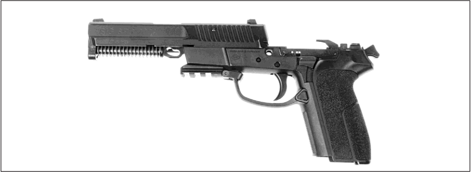
Figure 8 : Glisser la boîte de culasse depuis l'avant de la poignée pistolet
